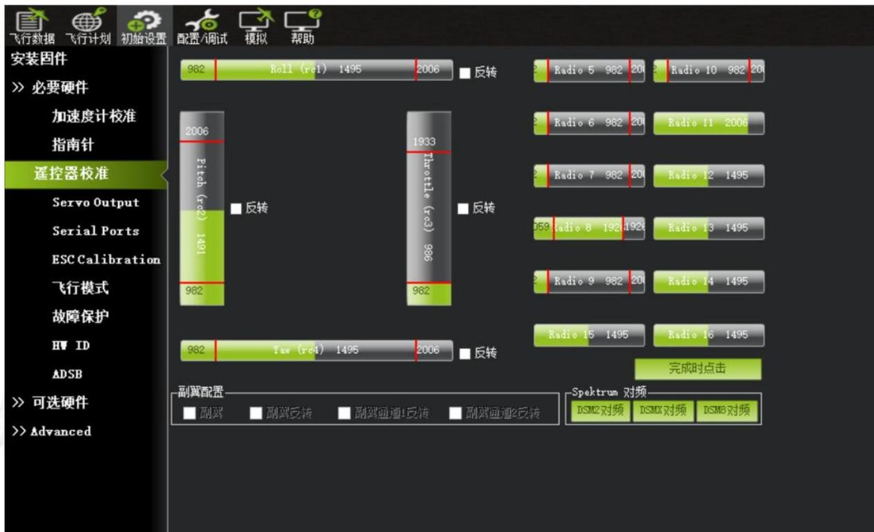
将所有通道的摇杆打满，开关通道及6端开关通道打满，可以在画面中开到通道是输出最大值和最小值有红色栏进行圈定，点击OK。
