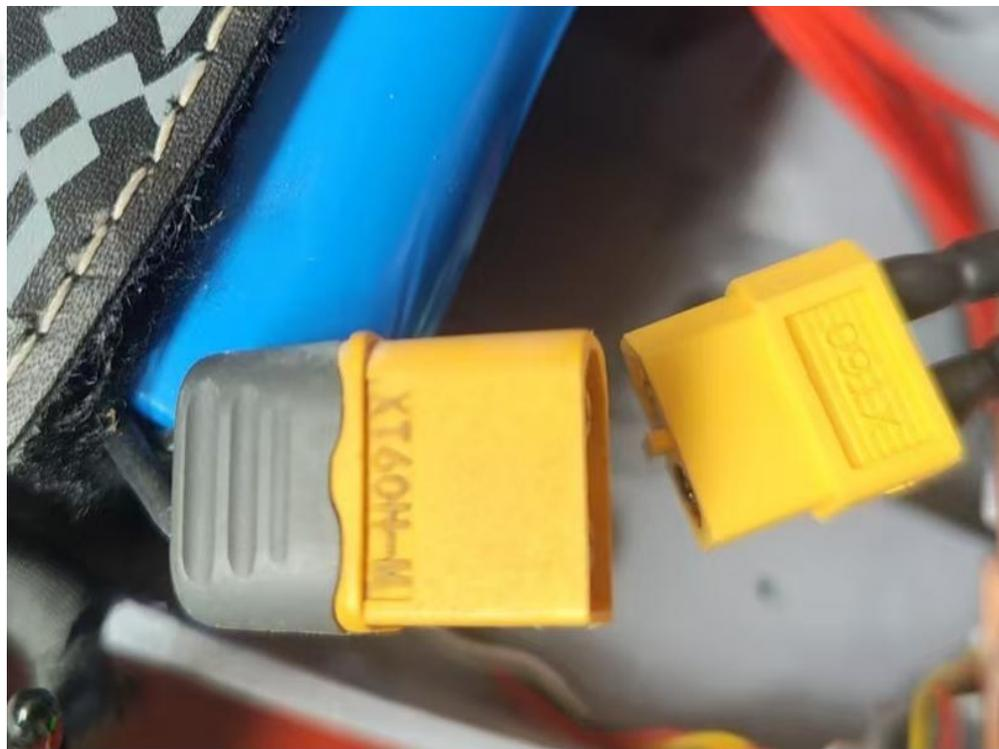
将电池连接飞控电源输入端，等待电调进入行程校准模式。
