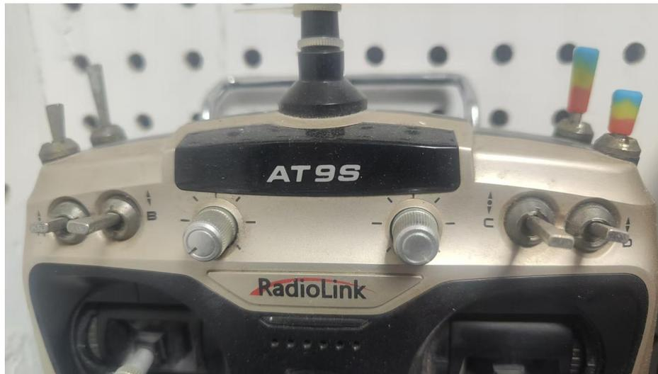
若出现不能6个飞行模型，请校准遥控器
