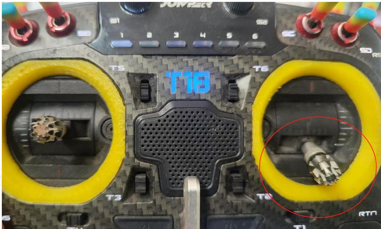
将油门拉到最低位，电调自动保存后，完成电调行程校准。
